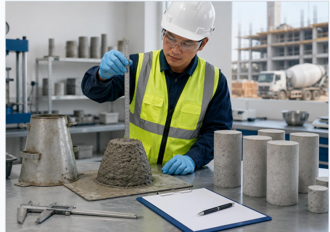
Uji slump untuk keputusan penerimaan beton
